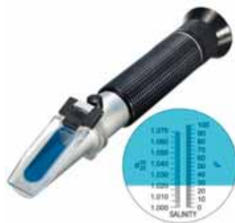
Рис. 10.4. Рефрактометр для измерения относительной плотности мочи
